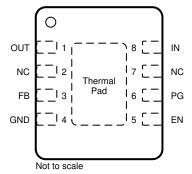
Figure 5-3. DRB Package, 8-Pin Adjustable VSON (Top View)
