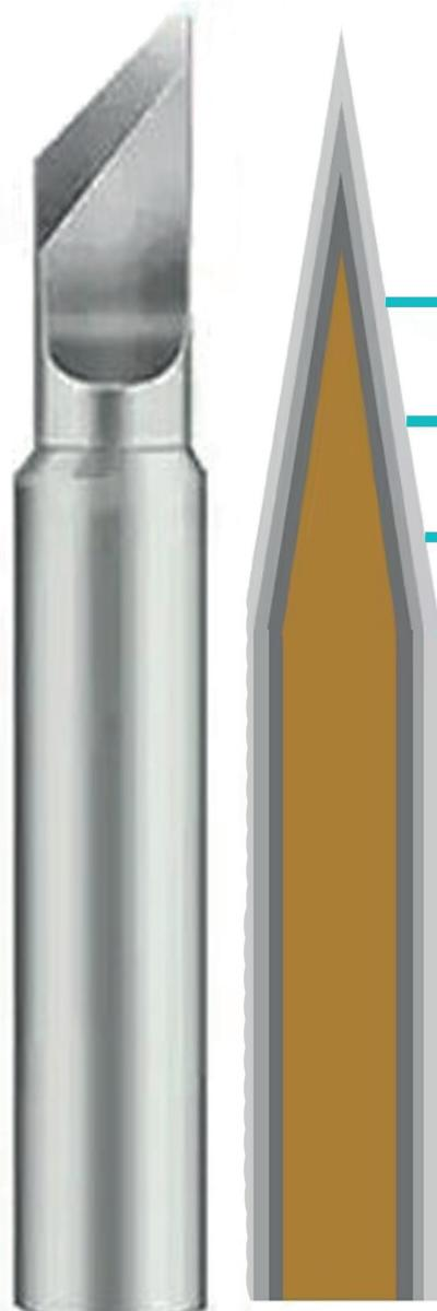
**CU****Fe****Ni****Cr****CU** Mükemmel ısı iletim performansı**Fe** Uçların ömrünü belirleyen Fe-Antikorozif**Ni** Fe kaplamayı koruyan Ni-Anti-pas, Cr kaplama işlemeye yardımcı olur**Cr** İslatılmayan, erimiş kalayın uç gövdesine geçmesini öner
