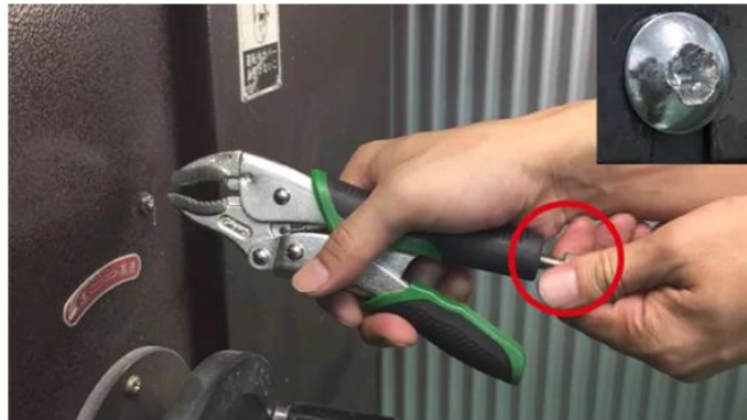
Step 1 : Loosen the adjusting bolt.
