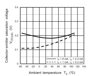
Fig. 11.10 V<sub>CE(sat)</sub> - T<sub>a</sub>
