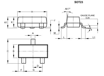
SOT23 Dim Min Max Тур 0.51 0.40 А 0.37 В 1.20 1.30 1.40 С 2.50 2.30 2.40 D 0.89 1.03 0.915 F 0.45 0.60 0.535 G 1.78 2.05 1.83 Н 2.80 3.00 2.90 J 0.013 0.10 0.05 κ 0.890 1.00 0.975 **K1** 0.903 1.10 1.025 0.55 L 0.45 0.61 L1 0.25 0.55 0.40 М 0.085 0.150 0.110 0° а 8° ---All Dimensions in mm
