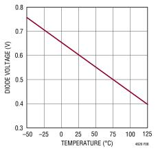
Figure 8. Diode Voltage V<sub>D</sub> vs Temperature T(°C)
