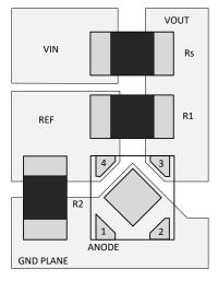
Figure 42. DQN Layout Example
