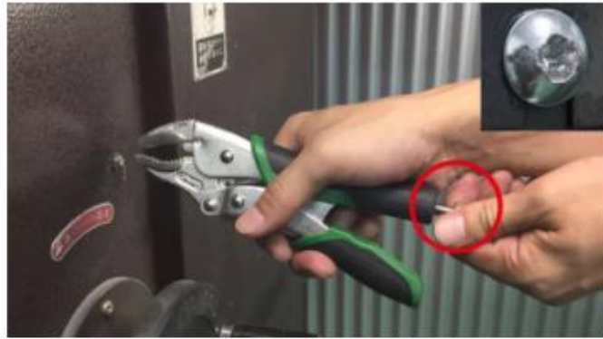
Step 1 : Loosen the adjusting bolt.
