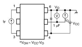
Fig. 13.1.3 V<sub>OH</sub> Test Circuit
