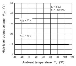
Fig. 13.2.8 V<sub>OH</sub> - T<sub>a</sub>
