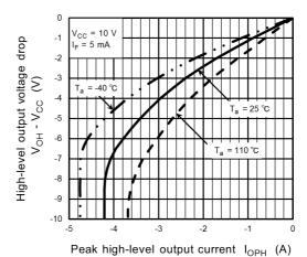
Fig. 13.2.10 (V<sub>OH</sub> - V<sub>CC</sub>) - I<sub>OPH</sub>
