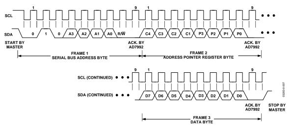
Figure 26. Single-Byte Write Sequence
