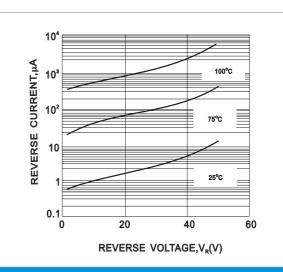
FIG. 2-TYPICAL REVERSE CHARACTERISTIC
