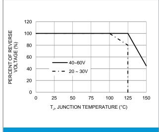
Fig.5- OPERATING TEMPERATURE DERATING CURVE
