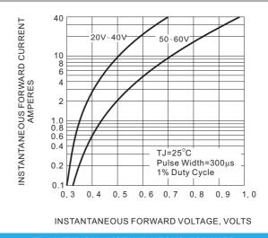
Fig. 4-TYPICAL INSTANTANEOUS FORWARD CHARACTERISTIC
