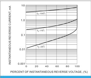
Fig. 3-TYPICAL REVERSE CHARACTERISTIC
