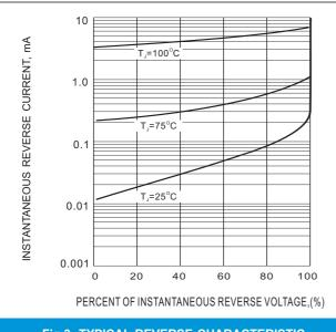
Fig.3- TYPICAL REVERSE CHARACTERISTIC
