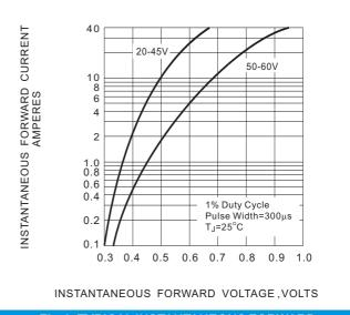
Fig.4- TYPICAL INSTANTANEOUS FORWARD CHARACTERISTIC
