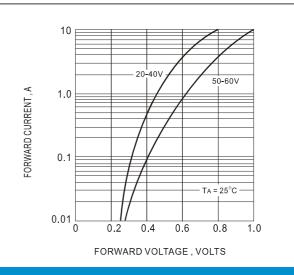
Fig.4 TYPICAL INSTANTANEOUS FORWARD CHARACTERISTIC
