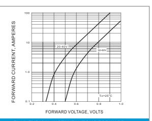
Fig.2 TYPICAL INSTANTANEOUS FORWARD CHARACTERISTIC
