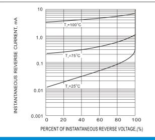
Fig.3- TYPICAL REVERSE CHARACTERISTIC
