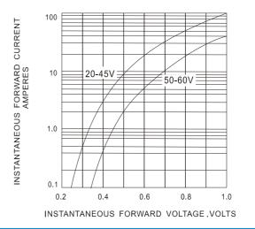
Fig.4- TYPICAL INSTANTANEOUS FORWARD CHARACTERISTIC
