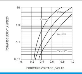
Fig.4 TYPICAL INSTANTANEOUS FORWARD CHARACTERISTIC
