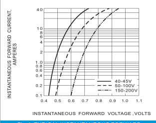
Fig.4 TYPICAL INSTANTANEOUS FORWARD CHARACTERISTIC
