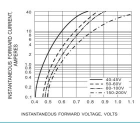
Fig.4 TYPICAL INSTANTANEOUS FORWARD CHARACTERISTIC
