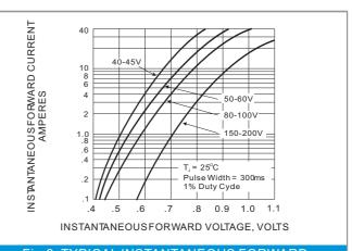
Fig.2 TYPICAL INSTANTANEOUS FORWARD CHARACTERISTICS
