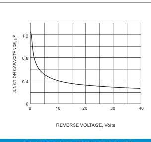
FIG. 3 TYPICAL JUNCTION CAPACITANCE
