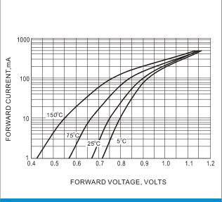
Fig.3 TYPICAL FORWARD VOLTAGE
