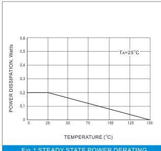
Fig.1 STEADY STATE POWER DERATING
