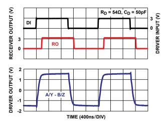
FIGURE 28. V<sub>CC</sub> = 3.3V, DRIVER AND RECEIVER WAVEFORMS (ISL32453E, ISL32455E)
