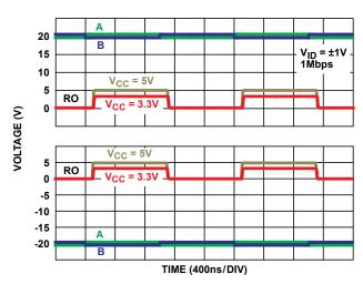
FIGURE 25. ±20V RECEIVER PERFORMANCE (ISL32453E, ISL32455E)
