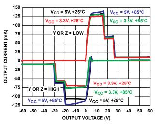
FIGURE 17. DRIVER OUTPUT CURRENT vs SHORT-CIRCUIT VOLTAGE
