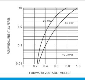
Fig.4 TYPICAL INSTANTANEOUS FORWARD CHARACTERISTIC
