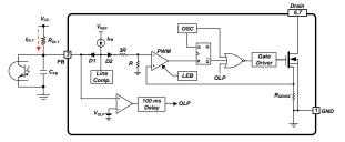
Figure 21. OLP Circuit
