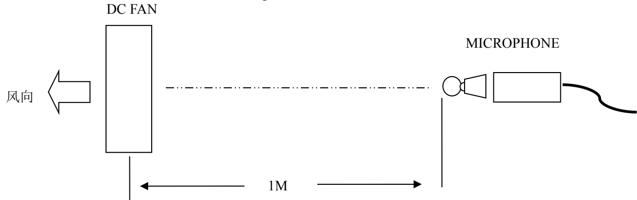
9-1.噪音测试方法示意图（Schematic diagram of noise test method）：
