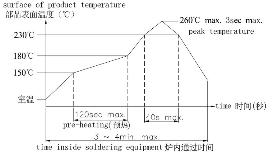
注意：以上提及的条件是零部件上PWB表面的温度，由于PWB的材料、尺寸、厚度等不同，PWB从开关表面获得的温度也会有很大不同，因此，千万小心不要让开关表面温度超过260°C
