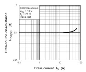
Fig. 8.6 R<sub>DS(ON)</sub> - I<sub>D</sub>
