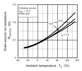
Fig. 8.7 R<sub>DS(ON)</sub> - T<sub>a</sub>
