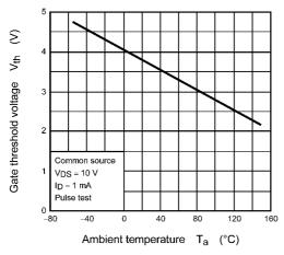
Fig. 8.11 V<sub>th</sub> - T<sub>a</sub>
