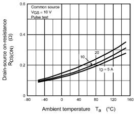
Fig. 8.7 R<sub>DS(ON)</sub> - T<sub>a</sub>
