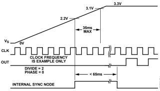
Figure 18. Power-On Sync Timing
